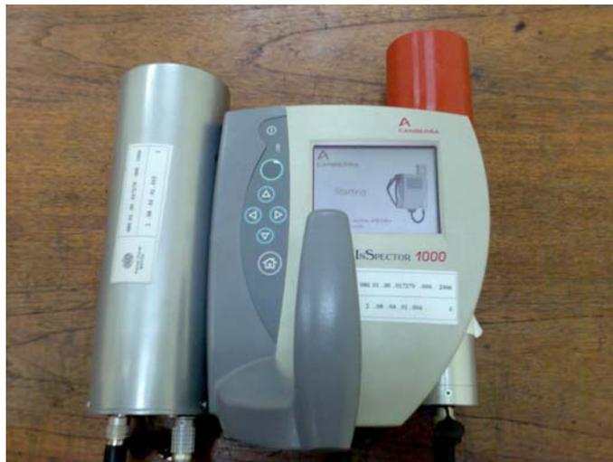
**Gambar 1.** Surveymeter InSpector™ 1000 dengan detektor gamma
