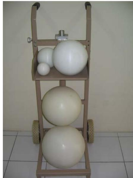
**Gambar 1.** Detektor  ${}^6\text{LiI}(\text{Eu})$  dan moderator polietelin berbentuk bola dengan diameter yang bervariasi mulai dari 2 s/d 12 inci
