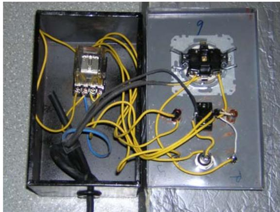
Gambar 2 Bentuk fisik instalasi komponen sistem proteksi power supply
