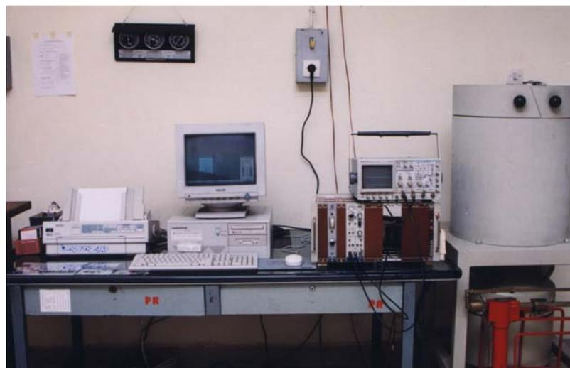
Gambar 1. Spektrometer gamma dengan detektor HPGe model GEM-25185 buatan EG&G Ortec
