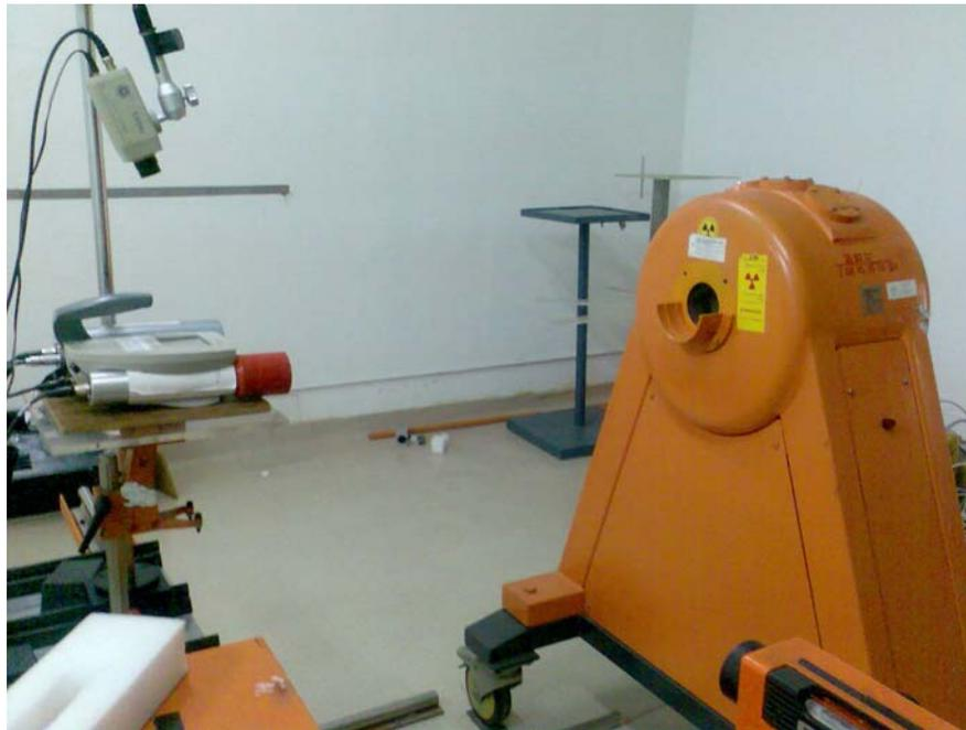
Gambar 2. Susunan peralatan pada saat kalibrasi surveymeter InInspector™ 1000 menggunakan sumber radiasi gamma <sup>137</sup>Cs dari kalibrator OB 85.
