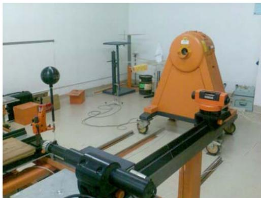
**Gambar 2.** Susunan peralatan pada saat kalibrasi dosimeter Standard Imaging terhadap dosimeter Farmer. Jarak detektor ke sumber radiasi = 200 cm.
