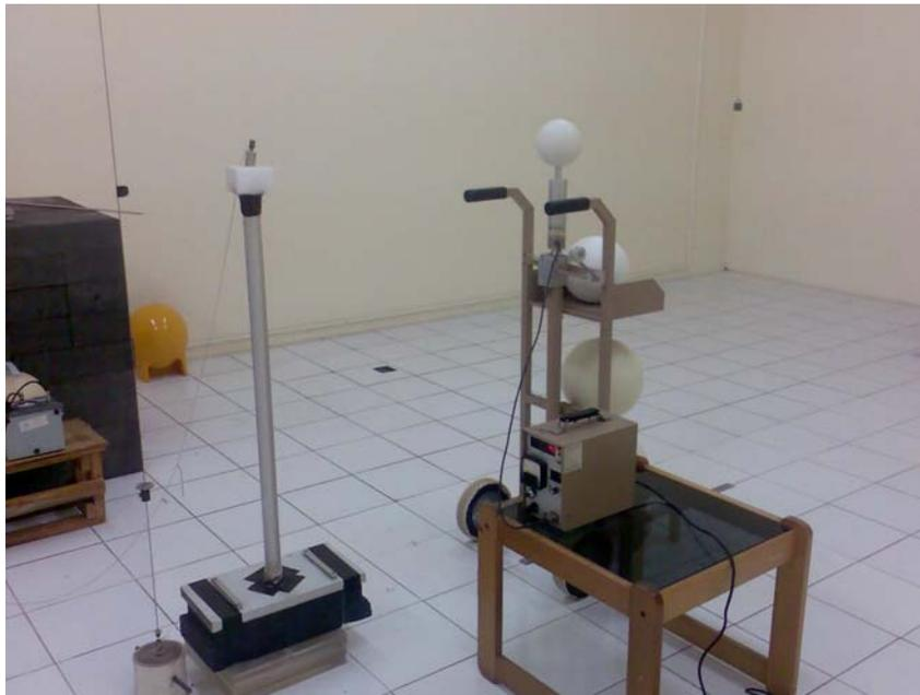
**Gambar 4.** Susunan peralatan pada pengukuran respon detektor *Bonner Multispheres* . Sumber radiasi neutron dan detektor diletakkan pada ketinggian 120 cm dari lantai dengan jarak detektor ke sumber radiasi bervariasi mulai dari 40 cm s/d 140 cm.
