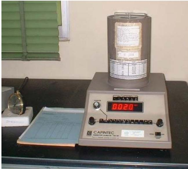
Gambar 2. Alat ukur standar *capintec* CRC-7BT
