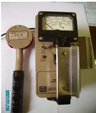
Gambar 1b. Surveimeter Ludlum Model 44-9 dan Scaler Ludlum – 1000.
