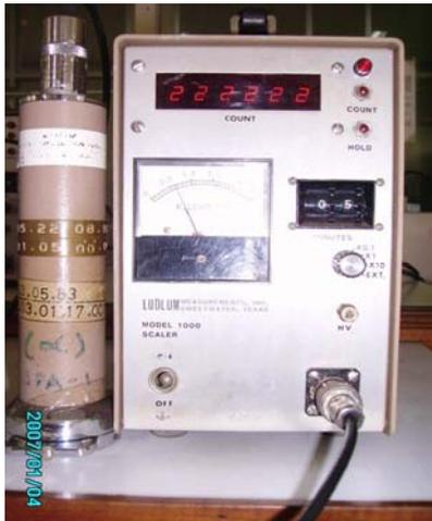
Gambar 1a. Surveimeter Ludlum Model-3 dengan detektor total ( $\alpha$ ,  $\beta$ ,  $\gamma$ )
