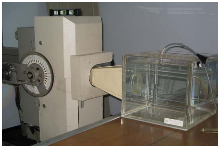
Gambar 1. Susunan peralatan pada pengukuran prosentase dosis di kedalaman berkas sinar-X pesawat Gilardoni. Ujung konus diletakkan menempel pada fantom air. Detektor diletakkan di dalam fantom air pada kedalaman 2,5 cm s/d 15 cm.
