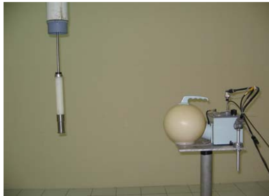
Gambar 1. Susunan peralatan untuk pengukuran respon detektor MK 7 NRM terhadap sumber radiasi neutron cepat ^{241}\text{Am-Be} .
