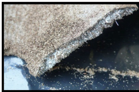
Ketika bahan yang mengandung asbes sudah rapuh, serat-serat asbes akan menjadi sangat mudah terlepas ke lingkungan (Sumber: abc.net.au, diunduh: 06 April 2015)
