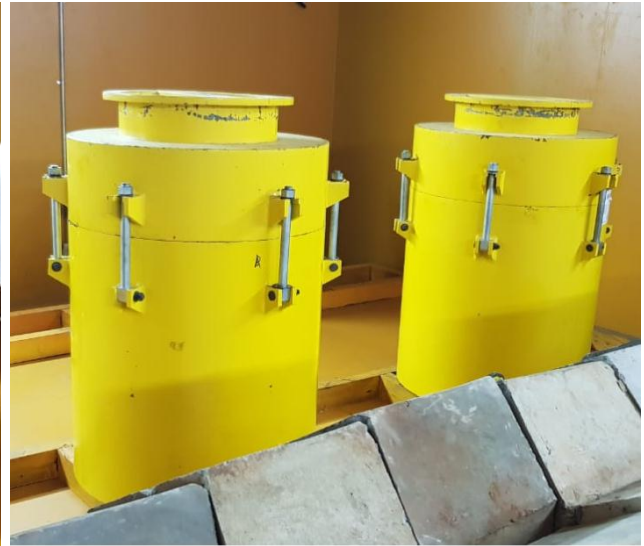
Gambar 4. Cel penyimpanan limbah radiasi tinggi
