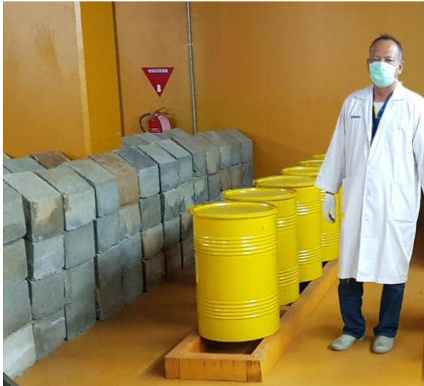
Gambar 3. Paving blok disusun disamping drum limbah radioaktif padat yang siap kirim
