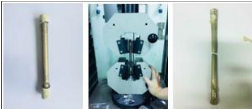
Gambar 3. Pengujian tarik transversal sampel SS316 dengan plunger resin.
