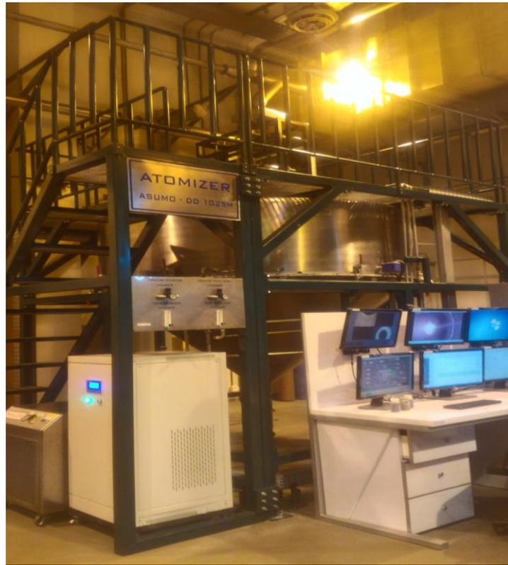
Gambar 3. Tungku induksi atomizer ASUMO DD-1025M
