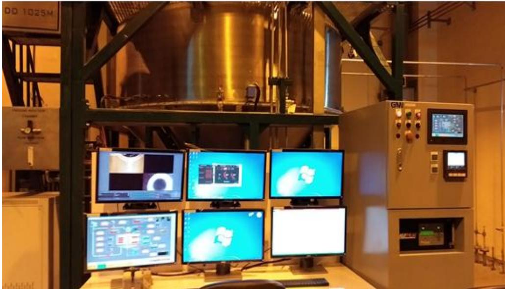
Gambar 4. HMI/SCADA pada tungku induksi atomizer ASUMO DD-1025M
