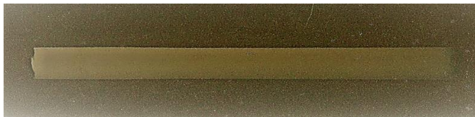
Gambar 5.8. Hasil pengujian white spots PEB U-6Zr-5Nb/Al
