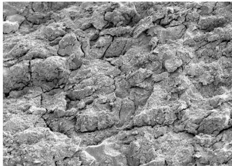
Gambar 4.2. Serbuk U-7Mo-1Ti hasil proses hidriding-dehidriding [14]
