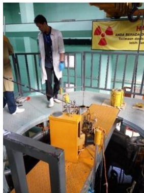
Iradiasi Target \text{MoO}_3 alam menggunakan Fasilitas Iradiasi Reaktor TRIGA Bandung
