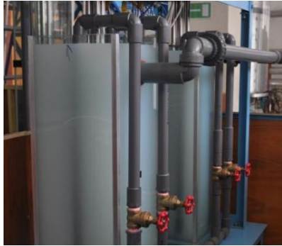
Alat Uji Sub Buluh Vertikal untuk Pengujian Pendingin Reaktor
