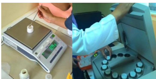
Preparasi Kandidat RM CFA untuk uji homogenitas menggunakan XRF
