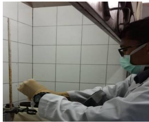
Pemisahan ^{161}\text{Tb} dari target ^{160}\text{Gd} dengan kromatografi ekstraksi
