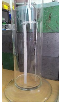
Penentuan Kemurnian Radiokimia ^{113m}\text{In} dengan Kromatografi Kertas
