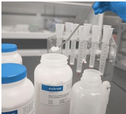
Ln Resin yang digunakan dalam Kromatografi Ekstraksi
