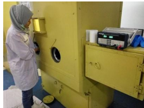
Pemisahan ^{99m}\text{Tc} dari ^{99}\text{Mo} menggunakan Metode Elektrokimia
