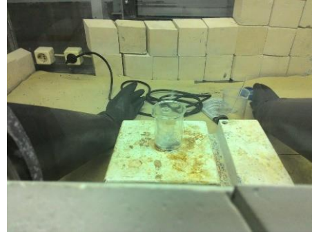
Pelarutan Target ^{113}\text{Sn} dalam Boks Proses
