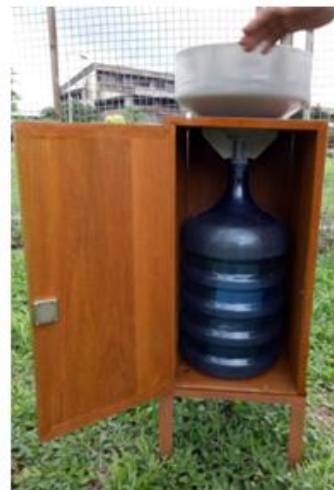
Gambar 1. Pencuplik air hujan menggunakan corong yang dialirkan kedalam galon
