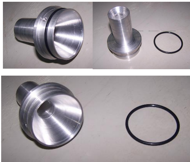
Gambar 5. Rancangan reducer masukan dan keluaran jalur pencuplik udara
