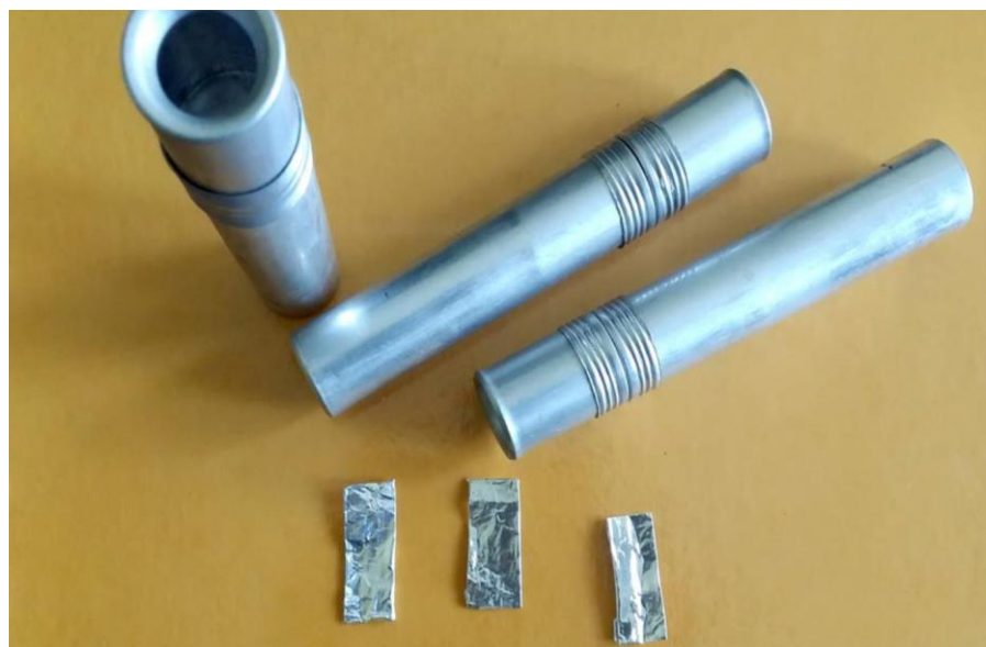
Gambar 5. Target Gd 2 O 3 diperkaya isotop 160 Gd dalam aluminium foil yang dimasukkan ke dalam capsul aluminium
