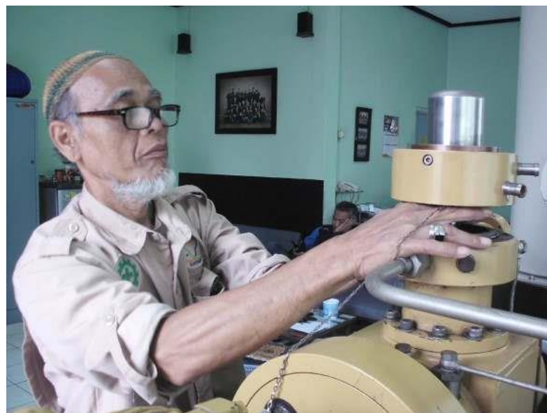
Gambar 9. Perbaikan mesin nitrogen cair
