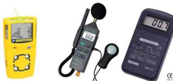
Gambar 6. Peralatan yang digunakan (gas alert portable gas detector, 4 in 1 environmeter, EMF tester)
