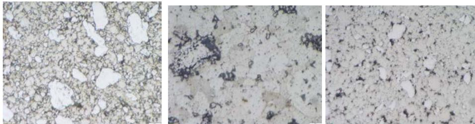
Gambar 5. Citra hasil mikroskop optik pada sampel setelah *sintering* dalam APS a) 4 menit b) 16 menit dan c) 22 menit.
