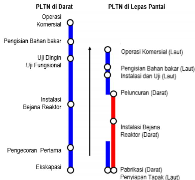
Gambar 8. Perbandingan Waktu Konstruksi PLTN di darat dan di lepas pantai[9]
