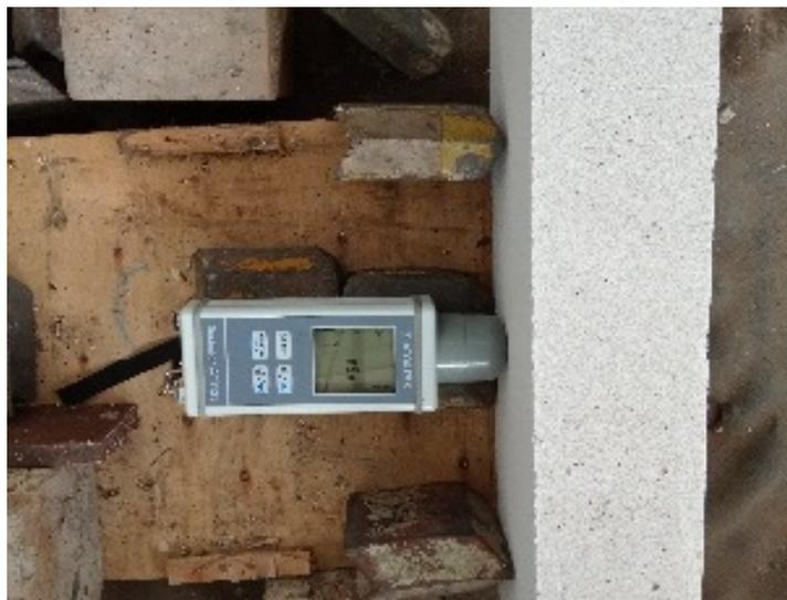
Gambar 3. Bata hebel dan alat Atomtex.
