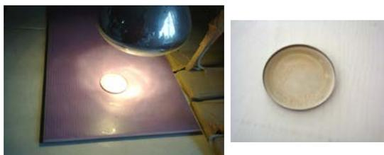
**Gambar 4. Preparasi Sampel Air Hujan Untuk Pengukuran Gross Beta Dengan LBC**
