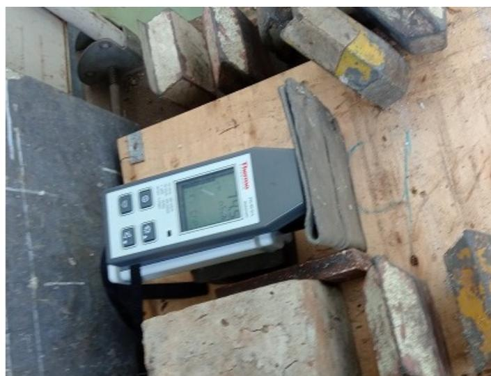
Gambar 4. Pelat Timah hitam dan alat Atomtex.
