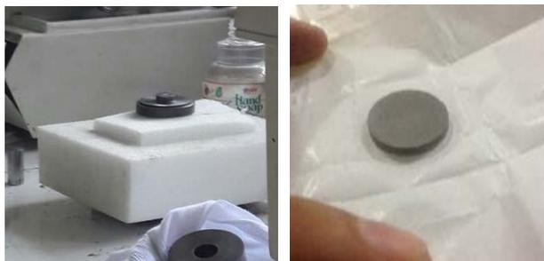
Gambar 4. (a) Alat vibrasi campuran bahan sebelum proses pengepresan buatan PSTBM-BATAN dan (b) Sampel baru setelah pengepresan.
