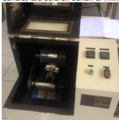
Gambar 3. High Energy Milling (HEM) produksi LIPI yang digunakan dalam penelitian ini.
