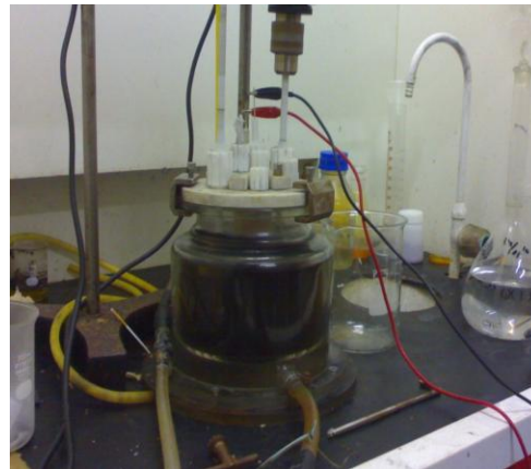
Gambar.2 Percobaan dekontaminasi solven organik (TBP) dengan oksidasi Ag^{+2}
