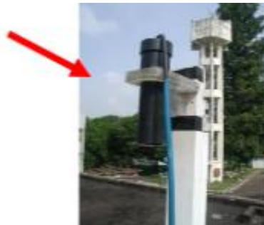
Gambar 26. Alat pencuplik udara Gent Stacked Filter Sampler terdiri dari pompa vakum (kiri) dan kontainer hitam berisi filter (kanan)
