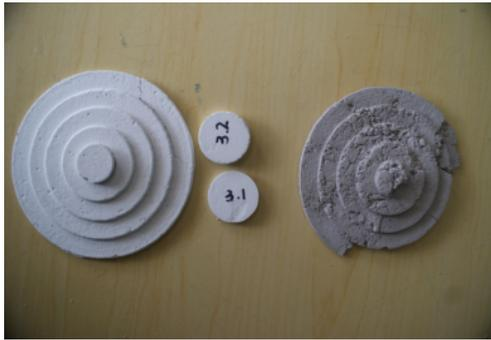
Gambar 5. Bentuk ketiga sampel dari kiri Zeolit +  $B_2O_3$ , Semen putih + *waterglass* +  $B_4C$  dan Semen +  $B_2O_3$
