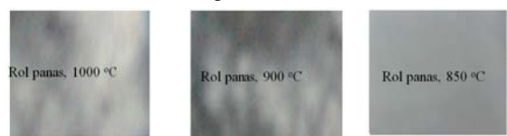
Gambar 6. Pelat hasil rol panas ingot Zr-Nb-Mo-Ge.
