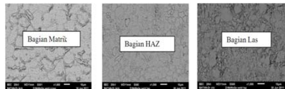
Gambar 9. Struktur mikro matrik, HAZ dan bagian lasan.
