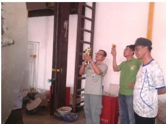
Gambar 2. Pengamatan sebaran panas menggunakan kamera infra merah dan termometer infra merah
