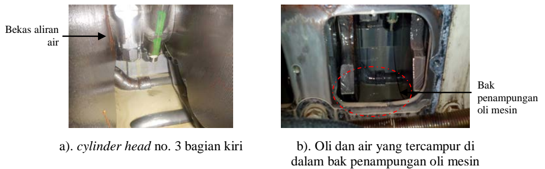
Gambar 9. Kondisi bagian dalam dari cylinder head No.3 sebelah kiri
