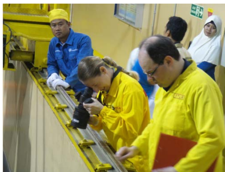
Gambar 6. Inspeksi BBNB Menggunakan Cerenkove pada PIV oleh IAEA
