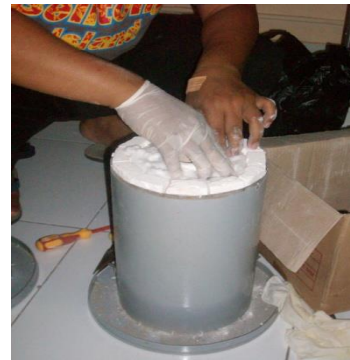
Gambar 6. Pemasangan Elemen Pemanas MSB
