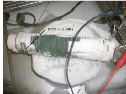
Gambar 3. Elemen pemanas yang rusak
