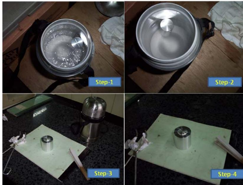
Gambar 2: Foto proses pembuatan sampel *shrink-fit* aluminium aloy A7075. Step-1 *plug* dimasukan ke dalam nitrogen cair, step-2 beberapa saat kemudian, step-3 sesaat setelah *plug* dimasukan ke dalam *ring*, step-4 pada kondisi stabil.
