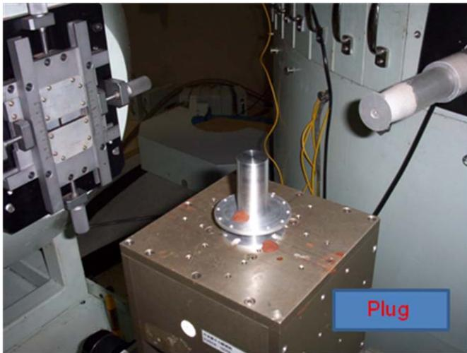
Gambar 5: Pengukuran mikrostrain pada *plug*.
