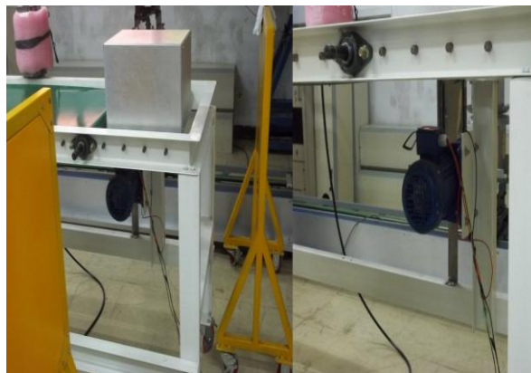
Gambar 2. Motor AC 3-Phase setelah dipasang di konveyor (bagian bawah)
