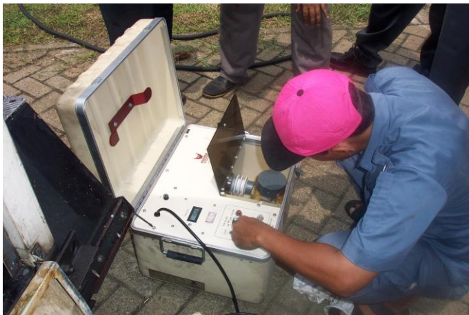
Gambar 3. Pengujian sampel minyak menggunakan Breakdown Voltage [3]
