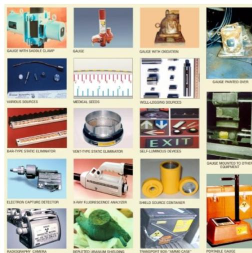
**Gambar 1.** Beberapa contoh wujud besi bekas terkontaminasi zat radioaktif (*radioactive scrap metal*), termasuk sumber radioaktif bekas[6]
