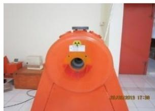
Gambar 4. Sumber Radiasi <sup>137</sup>Cs (OB-85) untuk mengkalibrasi TLD
