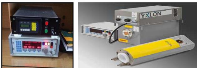
Gambar 2. Control Unit dan Pesawat Sinar-X / YXLON MG325
