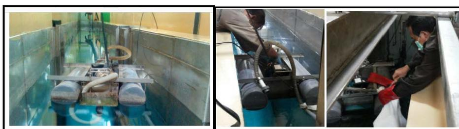
Gambar 1. Alat Skimer Penyaring Air Permukaan Kanal Hubung
