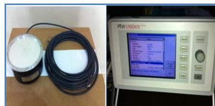
Gambar 3. Detektor Kamar Pengion dan electrometer PTW Unidose
