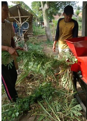
Gambar 4. Proses perajangan pakan tumbuhan dengan mesin chopper
