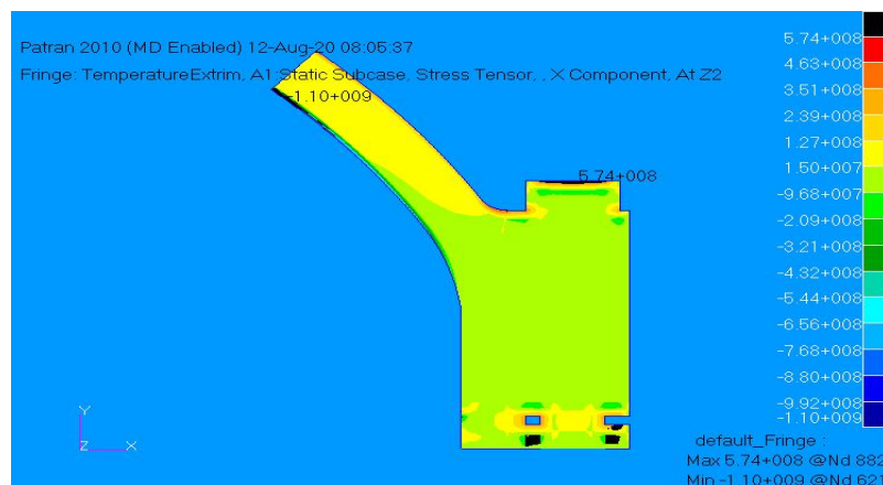
Gambar 7. Distribusi tegangan pada temperatur kondisi kehilangan cairan pendingin.
