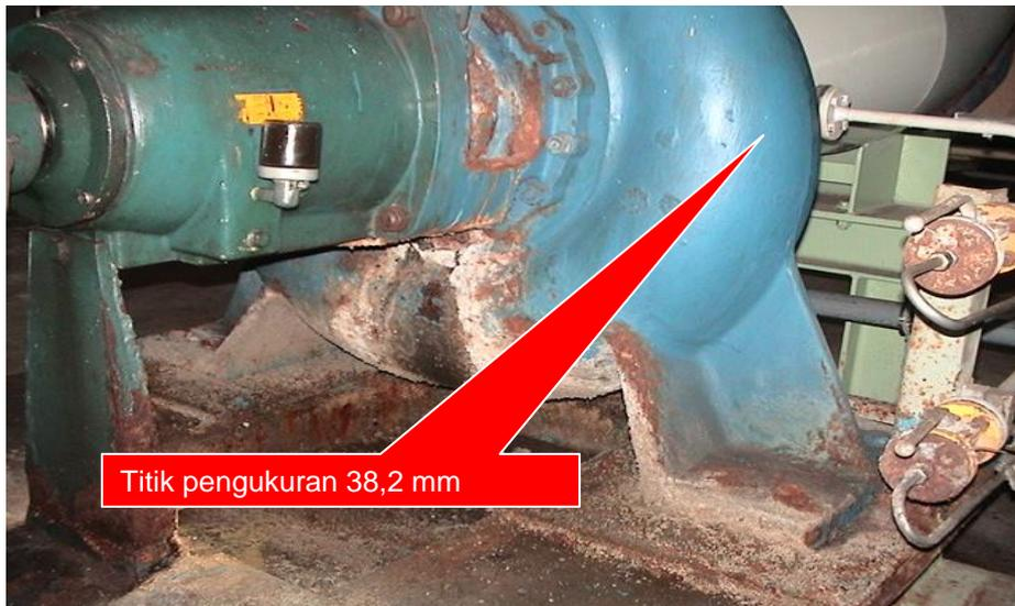
Gambar 2. Titik pengukuran ketebalan dinding pompa
