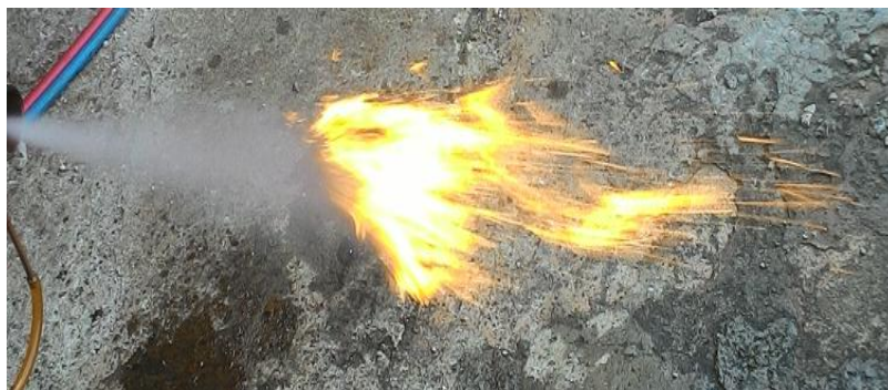
Gambar.2 Setting kesetimbangan pengkabutan campuran bahan bakar dan udara
