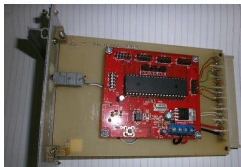
Gambar 6. Hasil perakitan Modul Mikrokotroller
