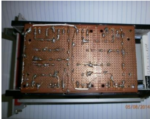
Gambar 7. Modul Driver Gamma Scanning setelah modifikasi
