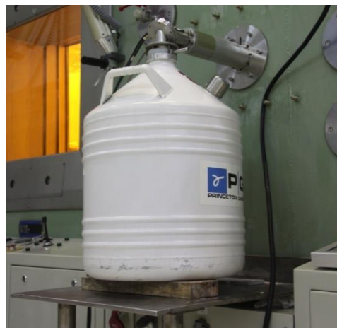
Gambar 13. Penempatan detektor gamma ke dinding hotcell RSG-GAS
