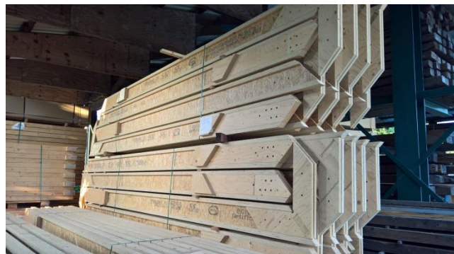
Gambar 5. Elemen Konstruksi Si-Modular yang sebagaina besar menggunakan I-Joist (Sumber : https://www.si-modular.net/ )
