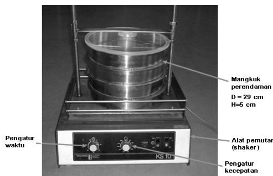
Gambar 1. Rangkaian Alat Perendaman
