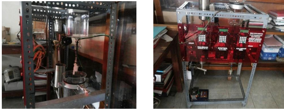
Gambar 6. Foto Penimbang Serbuk dan Cairan Umpan Pelarutan Otomatis
