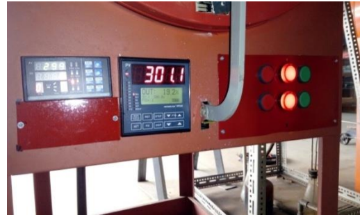
Gambar 19. Tampilan Uji Fungsi Tungku Kalsinasi 300 °C
