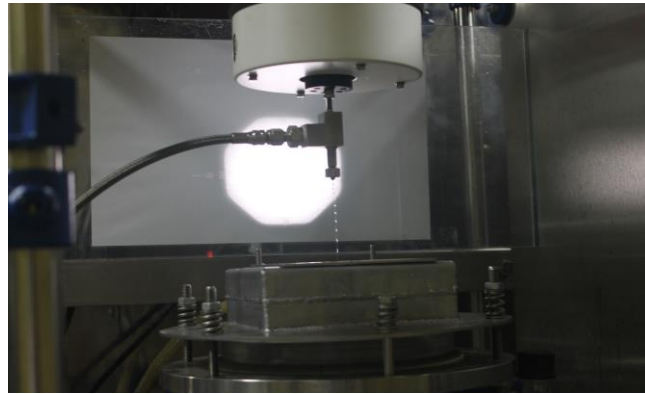
Gambar 8. Tetes Larutan Sol Yang Baik Pada Nozzle Penetes
