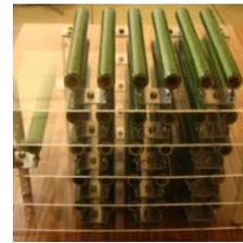
**Gambar 3.** Konstruksi komponen  $R_C$  dan  $R_D$  sistem ekstraksi elektron
