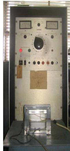
**Gambar 4.** Sistem tegangan tinggi ekstraksi Sumber Elektron Berbasis Katoda Plasma (SEBKP)-DUET (Dua Elektroda)
