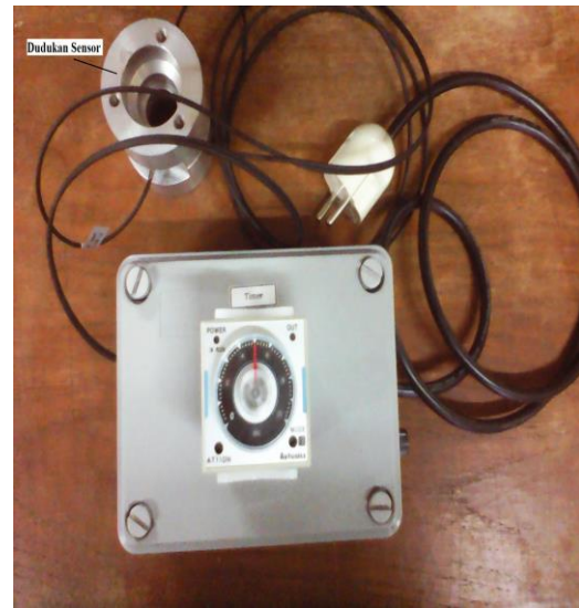
Gambar 14. Driver Katup Solenoid Lengkap dengan Dudukan Sensornya
