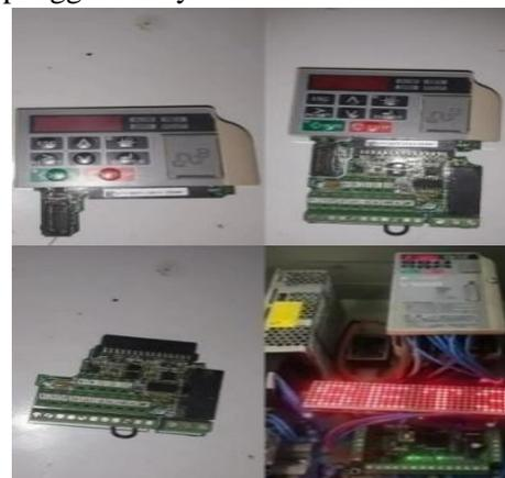
**Gambar 4.** Kerusakan Pada Modul *Inverter*
