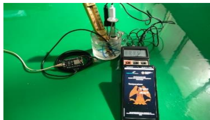
Gambar 7. Proses Pengujian Deviasi Alat Monitoring Suhu
