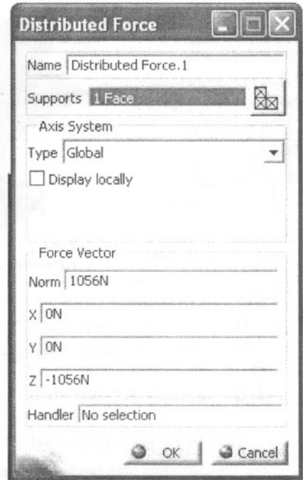
Gambar 6. Data masukan berupa simulasi beban 1056 N
