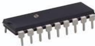
Gambar 5. Integrated Circuit (IC) dengan jenis Universal regulator switch
