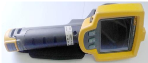
Thermal Imager FLUKE Ti32
