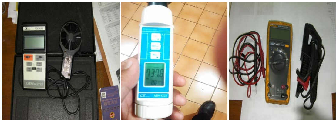
Gambar 4. Peralatan Anemometer, Manometer dan Multimeter
