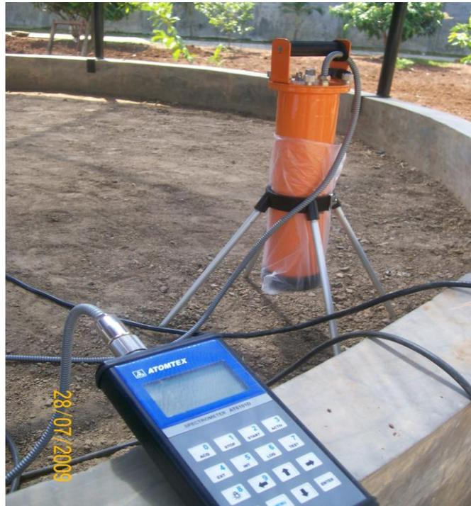
Gambar 2. Pengukuran aktivitas konsentrasi pada sumber kalibrasi TENORM dengan Spektrometer ATOMTEX AT 6101D
