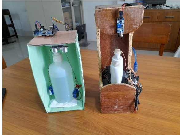
Gambar 3. Dispenser otomatis handsanitizer dengan sensor ultrasonik (kiri) dan sensor inframerah (kanan)
