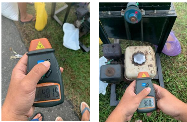
Gambar 11 Mengukur Putaran Puly Mesin Menggunakan Tachometer
