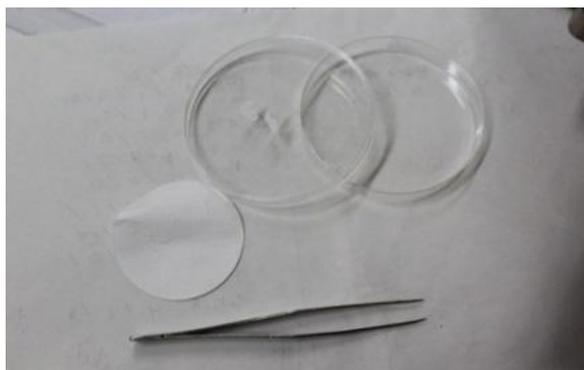
Gambar 4. Proses pengambilan sampel kontaminasi permukaan secara tidak langsung/tes usap.
