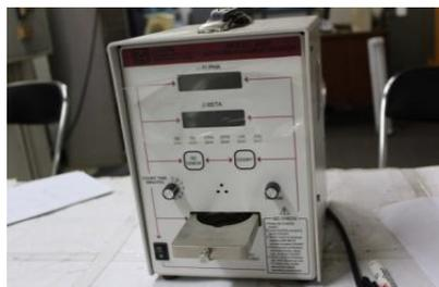
Gambar 5. Proses pencacahan kertas filter sampel kontaminasi udara/ permukaan
