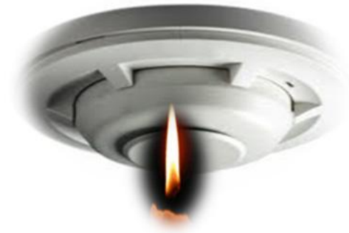
Gambar 1. Pengujian detektor panas api ( heat detektor ) dengan api lilin
