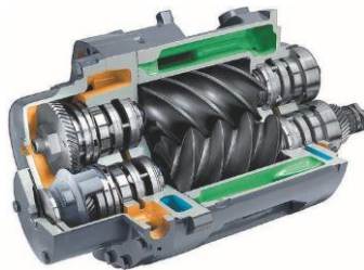
Gambar 1. Jenis kompresor screw
