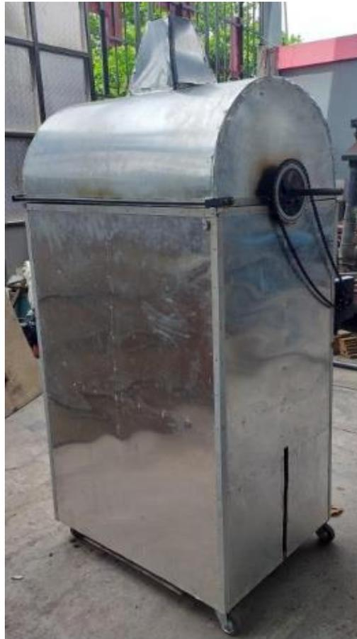
Gambar 1. Alat pengasapan ikan sistem rotari
