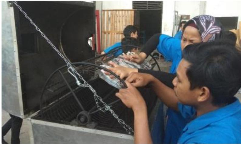
Gambar 2. Proses penempatan ikan pada rak pengasapan
