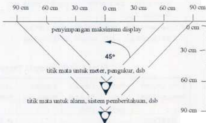
Gambar 5. Batas pandangan mata vertikal dan horisontal untuk seorang operator berdiri di muka panel pengendali
